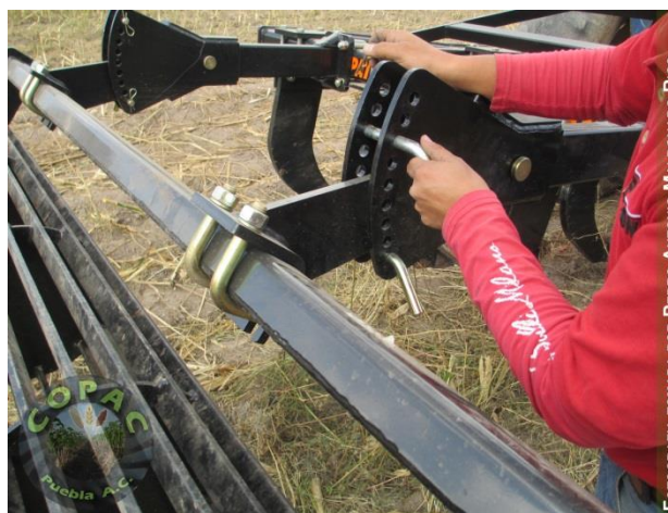
Figura 9 Ajuste para controlar la presión de trabajo del rodillo trasero de un Multicultivador.
