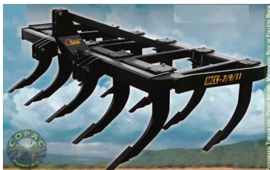
Figura 4 Multicultivador MCC 7/9/11 requiere un tractor de 150 hp de potencia y se puede utilizar con 7, 9 o 11 puntas según las condiciones del suelo.
