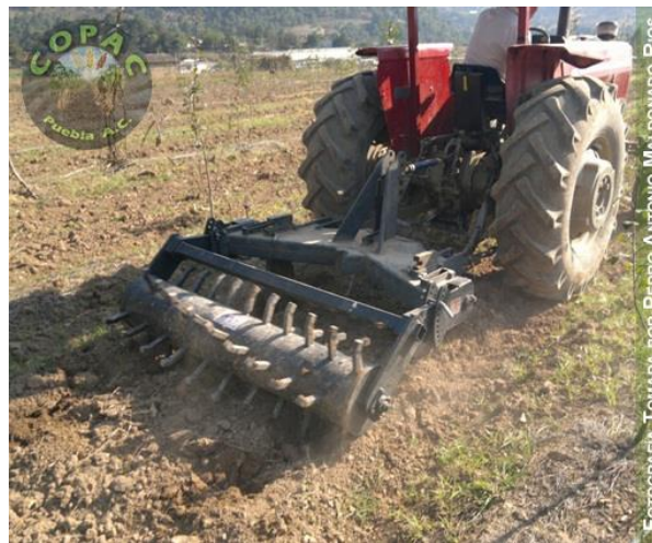
Figura 7 Sub suelo 3 puntas equipado con rodillo de martillos para suelos duros, observe el trabajo final después de una pasada del implemento.
